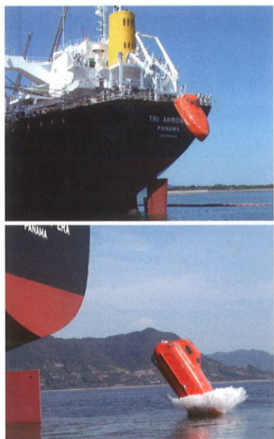
有人降下試験のデータを蓄積し完成した初の純国産自由降下式救命艇
